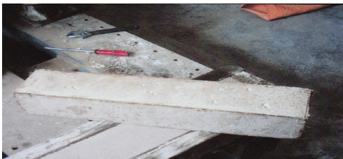
شكل ٥. خلطة جص وماء مع إضافة قشور الرز على شكل موشور
