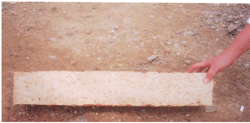
شكل ٤. خلطة جص وماء مع إضافة نشارة الخشب على شكل موشور
