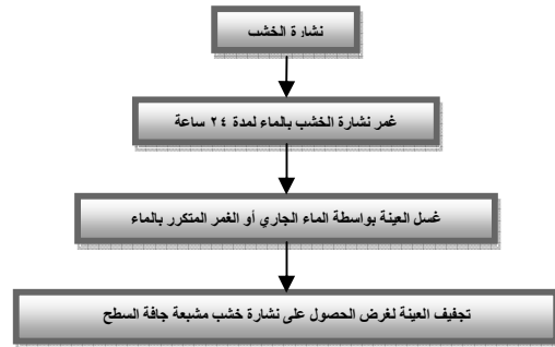
شكل ١: مخطط العمليات المطلوبة لتحضير نشارة الخشب
